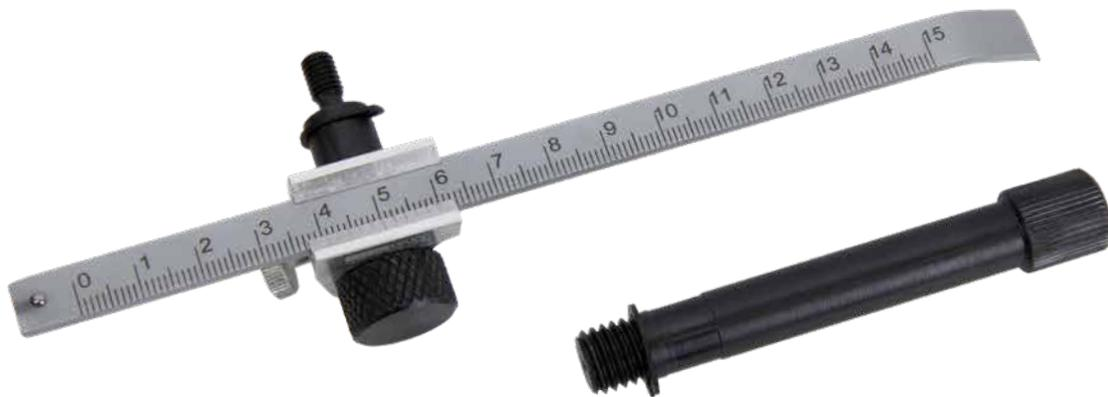
Die traditionelle Einstellvorrichtung wurde oft verwendet um bei älteren VAG Fahrzeugen, bei abgebautem Getriebe, den OT zu finden, da sich die Einstellposition oft am Schwungrad und in einer Bohrung am oberen Getriebegehäuse befand. Diese Einstellvorrichtung wird nun wieder an EA897 Generation 1 & 2 V6 TDI Common Rail Motoren verwendet. Es dient nun zum Einmessen und dem Einstellen des Zwischentriebs und somit der Nockenwelleneinstellung.
