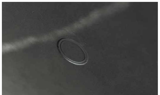
NACHGERÜSTETER PDC-SENSOR - AUSSENANSICHT
