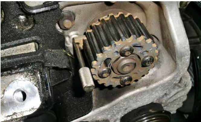
ABSTECKDORN FÜR NW / KW / EINSPRITZPUMPE KT10032
