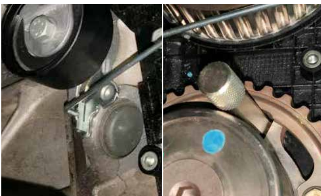
ARRETIERWERKZEUG FÜR SPANNROLLE KT10069 & NOCKENWELLE 106285
