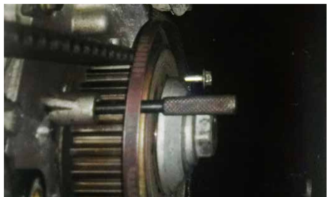
EINSTELLWERKZEUG FÜR KURBEL- / NOCKENWELLE, EINSPRITZPUMPE KT10032
