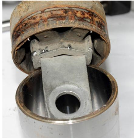
Zum **Auspressen** wird die Presshülse Art.-Nr. 106487 - ohne Stufe - benötigt.
