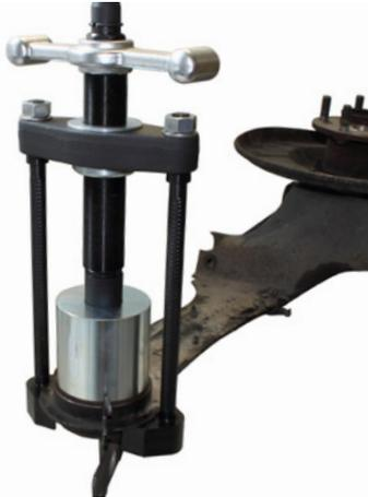
Das **Auspressen** erfolgt mithilfe der unteren Platte Art.-Nr. 106624 - ohne Stufe (Bestandteil Erweiterungssatz).
