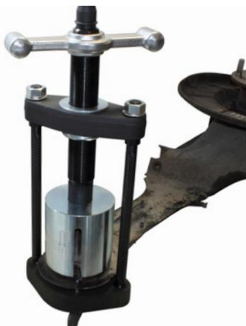
Das **Einpressen** erfolgt mithilfe der unteren Platte Art.-Nr. 100661 - mit Stufe (Bestandteil Pressrahmen).
