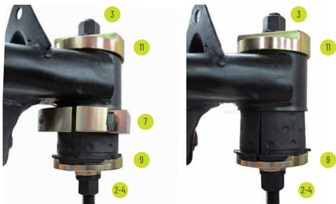
EINBAU HINTERACHSBUCHSE VORNE
