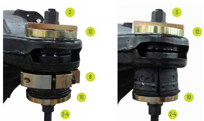
EINBAU HINTERACHSBUCHSE HINTEN
