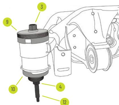
EINBAU HINTERACHSBUCHSE HINTEN
