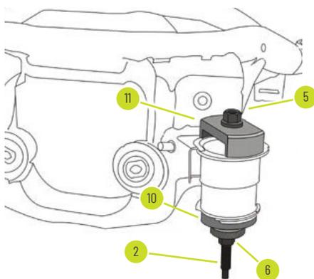
EINBAU HINTERACHSBUCHSE VORNE
